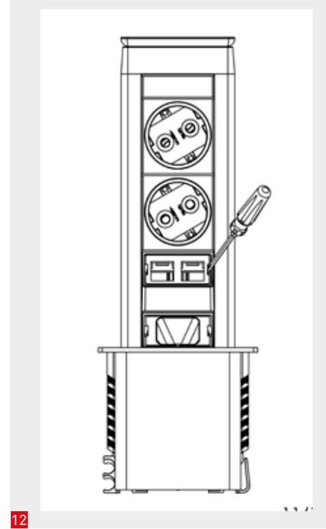
**10** Wechselmodul auswählen. Kabel für Ausbau komplett zugänglich machen.
